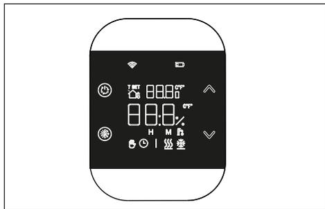
Terminato il test icone sul display appare per qualche secondo la versione firmware del T200.
