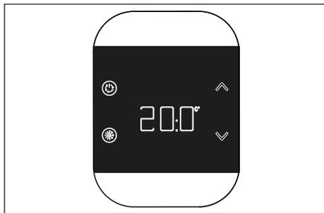
Per associare il dispositivo T200 ad un sistema, occorre attivare sul T300 la modalità di accoppiamento (fare riferimento al parametro RF del manuale del T300 per la procedura di ACCOPPIAMENTO) e successivamente premere il tasto presente all'interno del guscio inferiore. Durante la fase di accoppiamento, sui digit centrali lampeggia la scritta "RF" abbinata alla scritta "PAI" (Pairing-Accoppiamento).
